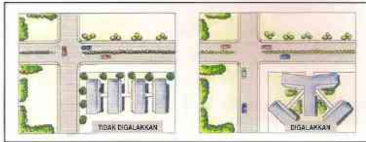
Penyusunan Bangunan Jenis Berek Tidak Digalakkan.
