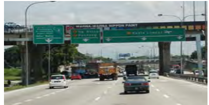
Papan iklan jejambatan yang diletakkan berdekatan dengan papan tanda lalu lintas (traffic sign) menyukarkan pengguna untuk membaca papan tanda lalu lintas.
